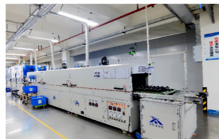
全自动灌胶线 Fully automatic glue pouring line
